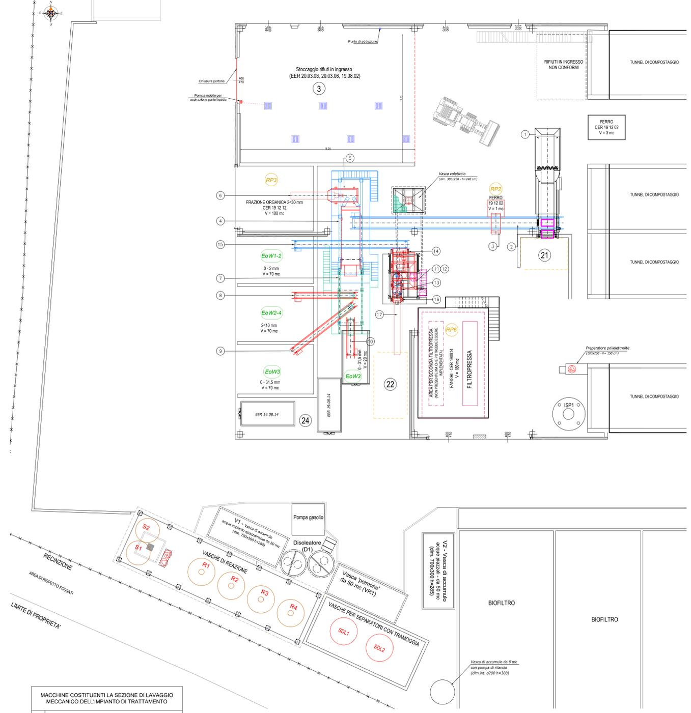
MACCHINE COSTITUENTI LA SEZIONE DI LAVAGGIO MECCANICO DELL'IMPIANTO DI TRATTAMENTO
